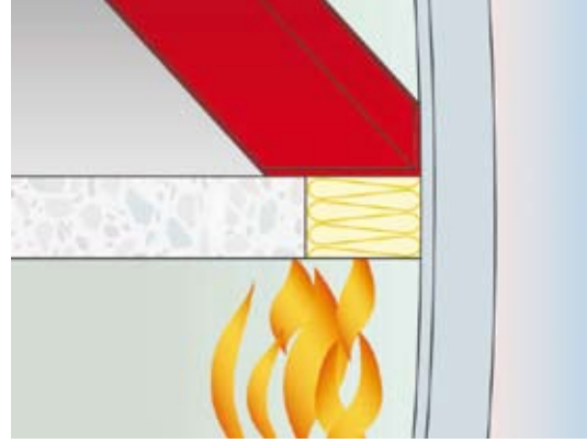
Şekil 8. Cephe ve döşeme arasında kalan yüksek hareketli derzlerin yalıtılmasında kullanılan spray mastik uygulaması.
