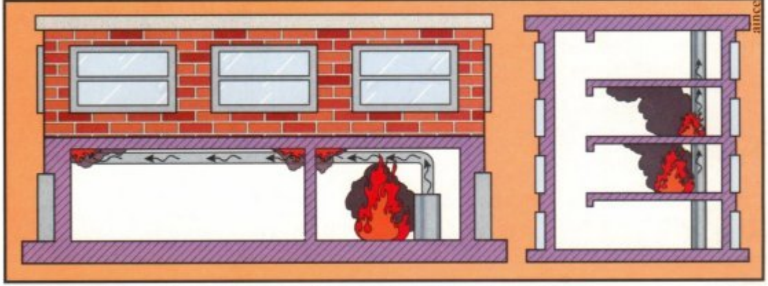
Şekil 3: İLETİMLE (CONDUCTION) ISI TRANSFERİ: Isıl iletken olan metal borular, ısıyı uzak mesafelere aktararak etrafındaki yanıcı maddelerin sıcaklığını tutuşma noktasına yükseltir ve yanmalarına sebep olur.
