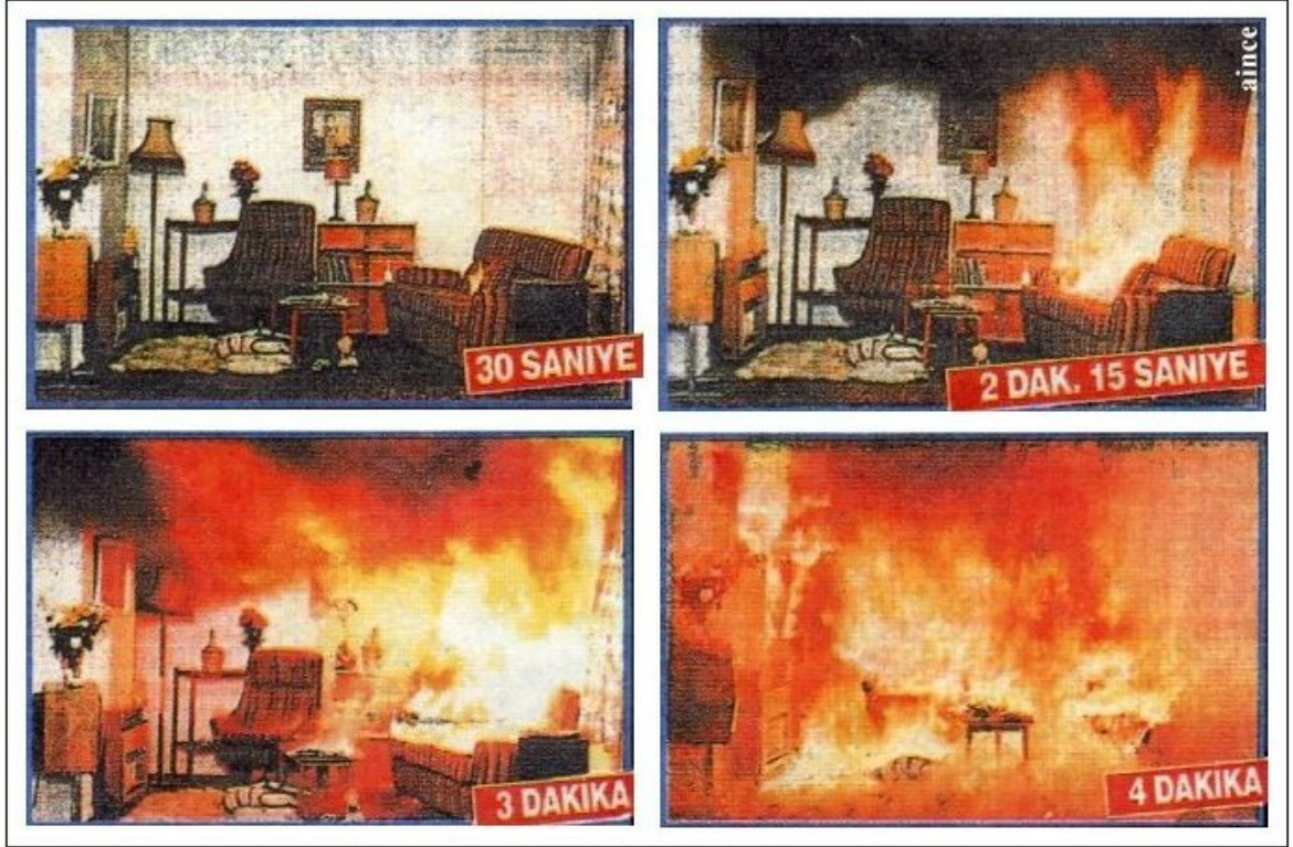
Şekil1: Yangının Büyüme Hızı Deneyi: Sıvılarda bu hız çok daha fazla, gazlarda ise anlaktır.
