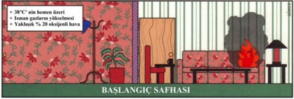
Şekil 6: Bir yangının ilk safhaları, yangının başlangıç safhası olarak değerlendirilir.
