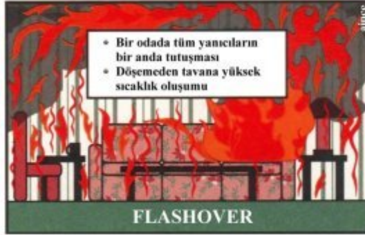
Şekil 10: Flashover olayında odadaki tüm yanıcı maddeler tutuşma sıcaklığına ulaşmıştır.
