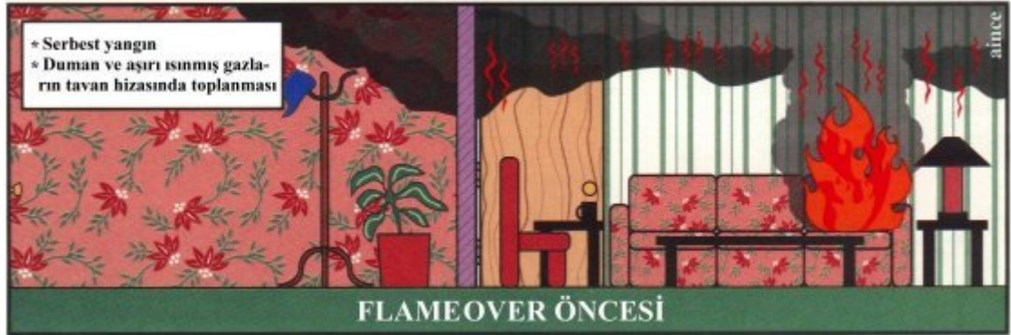
Şekil 7: Yarım yanmış gazlar tavan hizasında toplandığında Flameover öncesi durumu oluşur.
